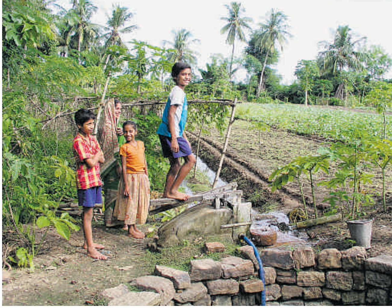
Die Pedalpumpe erlaubt die Bewässerung kleinerer Flächen für intensiven Anbau. Im Bild ein Beispiel aus Indien.
